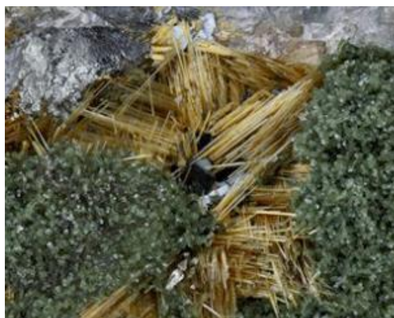
Rutile ( TiO_2 ) : gerbes de cristaux aciculaires millimétriques, dans la chlorite. Le Grand-Clot, Oisans (Isère).
