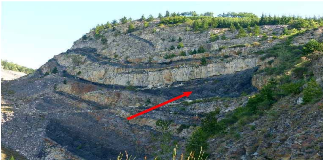
Figure 7. Épaisseur métrique des couches, pendage d'environ 40 % vers le sud ; le parement oriental découvre une tête faillée de pli anticlinal déversé vers le sud, avec un bourrage de charbon dans la charnière (flèche rouge). Cette morphologie relativement fréquente dans les couches de charbon, qui présentent amincissements et épaississements locaux, est due à la différence de comportement mécanique (compétence) entre le banc de grès sus-jacent, dur, cassant, et difficilement déformable, et la couche de charbon sous-jacente à structure schisteuse qui, elle, est facilement déformable.
