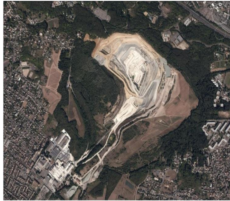
Figure 5. La carrière en 2015 : les zones remblayées anciennes sont végétalisées, les remblais récents ne le sont que partiellement.
